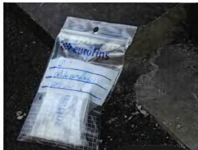
Composant : Colles des carrelages 2 (N) Colle des carrelages 30x30 Prélèvement n°2 : au sol au niveau de la porte d'entrée.
